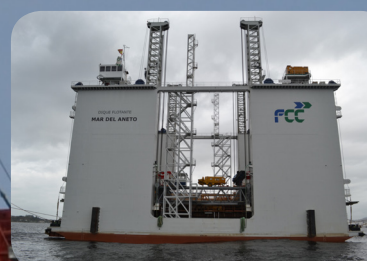
Dique flotante Mar de Aneto. Este cajonero, destinado a la construcción de diques, muelles y pantalanes tiene unas dimensiones de 46,8 metros de eslora y 32 de manga.
