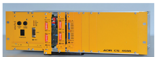
Estación de aforo y control de tráfico ADR 4500.
